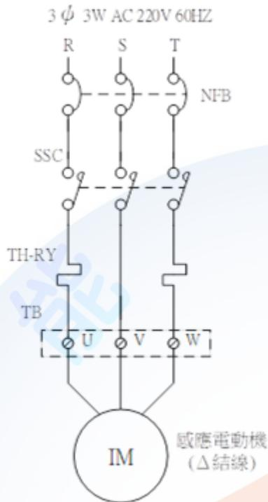
53. (1) (本題刪題)如下圖所示，當檢修時，若未切離感應電動機(IM)，此時於送電後，以三用電表量測固態接觸器(SSC)主接點二次側間之電壓值為 ①0V A ②220VA ③ $220\sqrt{3}$ VAC ④約為 220VAC 。
