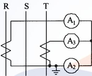
26. (1) 如下圖所示，三相電路連接單相負載 L，通過電流表  $A_1$  為 5A 時，電流表  $A_3$  指示應為 ①0A ②5A ③10A ④20A。
