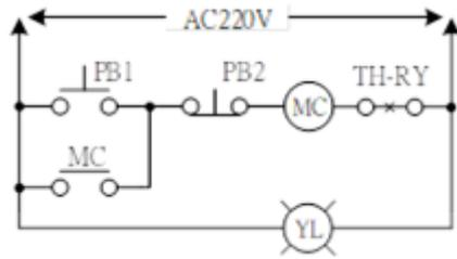
55. (2) 如下圖所示，電磁接觸器線圈之內阻值為  $300\Omega$ ，指示燈之內阻值為  $600\Omega$ 。通電後，若 PB1 或 PB2 均未動作，則電磁接觸器輔助 a 接點間之電壓值為 ①  $0\text{VAC}$  ②  $220\text{VAC}$  ③  $\text{VAC}$  ④  $220 \times 600 / 900\text{VAC}$ 。
