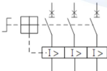
62. (1) 如下圖所示之歐規斷路器，若其規格為  $3\text{P}\ 220\text{VAC}\ 25\text{KA}\ 2.5 \sim 4\text{A}$  過載可調，瞬跳值為 10 倍以上，下列有關該器具之功能敘述何者錯誤？ ①當過
