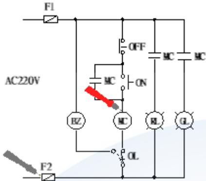
134. (3) (本題刪題)送電並按下 ON 開關後，使用三用電表做如下圖之測量，則三用電表檢測值為 ①0V ②110V ③220V ④380V 。
