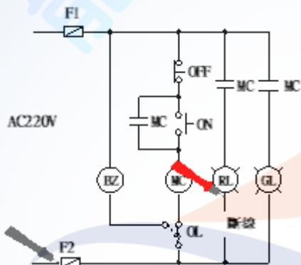
135. (2) 如下圖，PB、PL 及 BZ 裝置於操作面盤上，配置過門端子台時，最少須使用 ①5P ②7P ③8P ④10P 。
