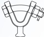
24. (3) 下圖輸電材料符號為 ①掛線夾板 ②拉線夾板 ③壓縮型終端夾板 ④球連環。
